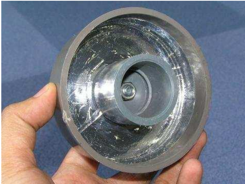
Dop Pipa Paralon 3 Inchi dan 1,25 Inchi digabung.
