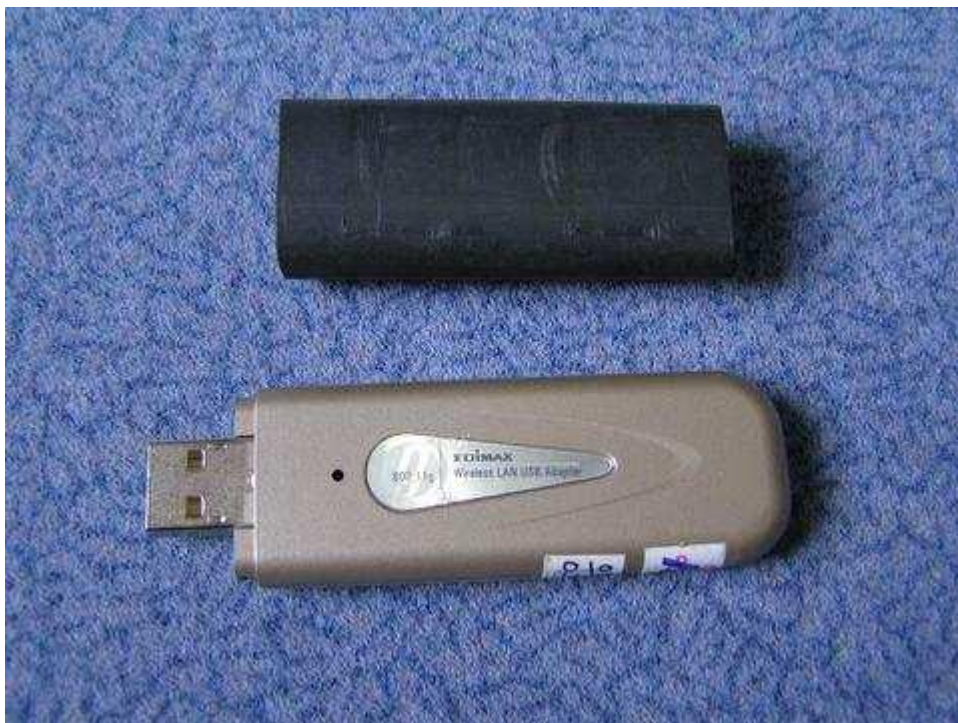
Masukan karet pelindung ke USB WLAN
