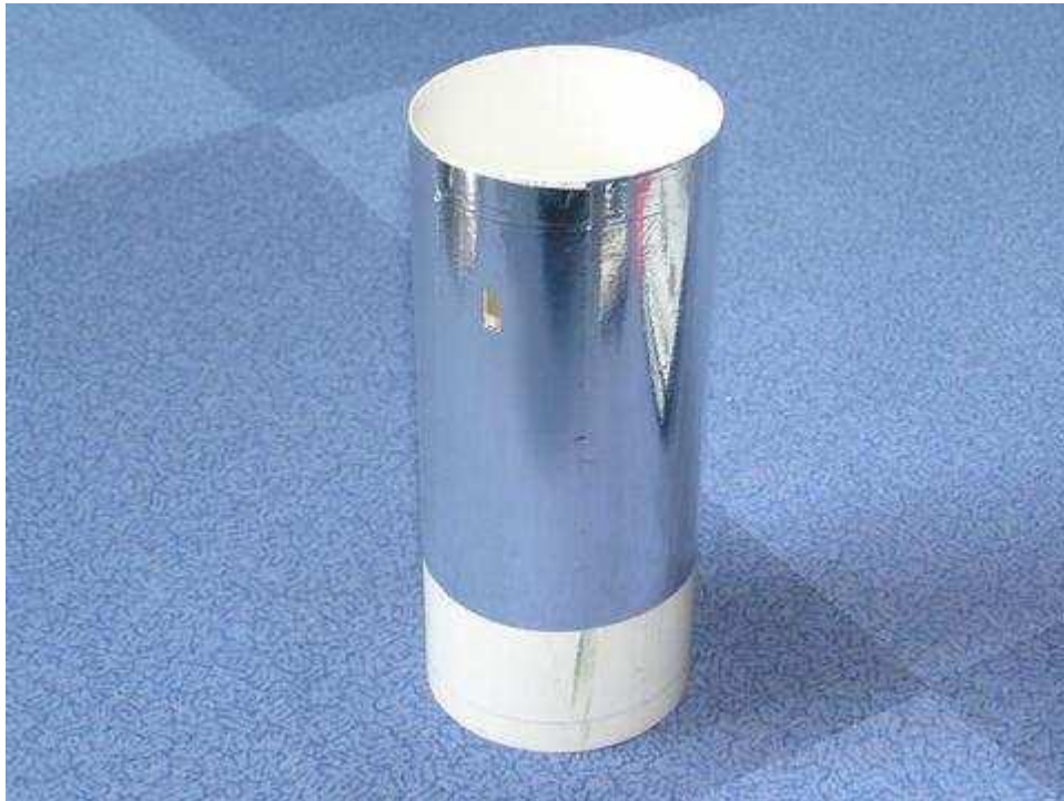
Pipa Pralon 3 yang sudah dilapisi lakban aluminium"
